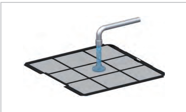
Abb. 25: Reinigung mit lauwarmen Wasser
